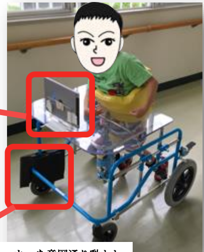
ウォーカーを意図通り動かしやすくする前輪ガード
