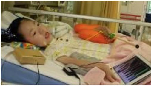
紐スイッチと i+Pad タッチャーを使って、「ピアノ」を演奏。紐を結んだバチを左手に持ち、腹筋を使ってお腹を上下させて紐スイッチを作動させる。i+Pad タッチャーに接続しているため、「FingerPiano」を演奏することができた。
